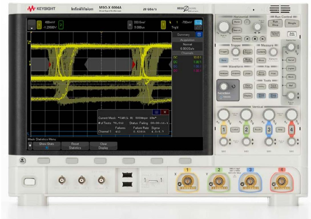
图 7 : 在 Keysight InfiniiVision 6000 X 系列示波器上运行的模板极限测试
