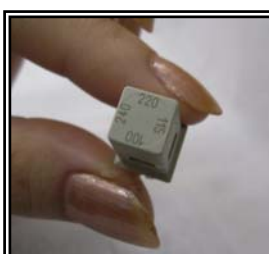
③. 电源电压根据灰色的保险丝盒的安装方向替换。 拔出保险丝盒，请确认电源电压的变更。 ④. 操作结束时，请将保险丝盒和保险丝座还原。
