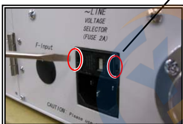
②. 用先端类似小的一字型螺丝刀的工具按住左右的爪，拔出保险丝座。 (在此种状态下交换电源保险丝。交换时请确认保险丝的规格。)
