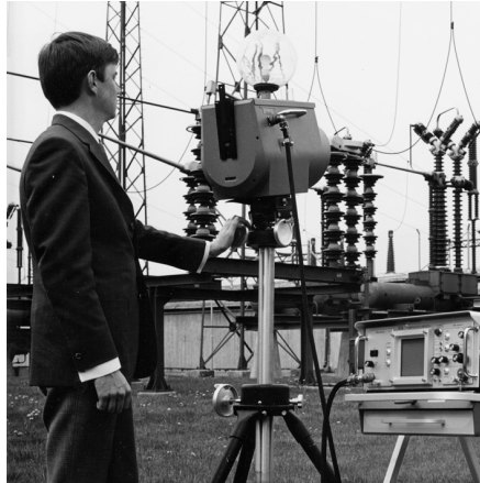
图 13.2 1969：Thermovision 661 型。这款热像仪重量大约在 25 千克左右，示波器重 20 千克，三脚架重 15 千克。操作员还需要一个 220 VAC 的发电机组，以及一个装有液氮的 10 升液罐。在示波器的左边，可以看见 Polaroid 配件（6 千克）。
