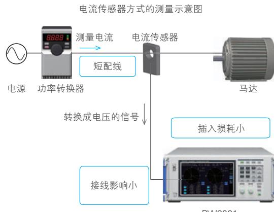
电流传感器方式的测量示意图
