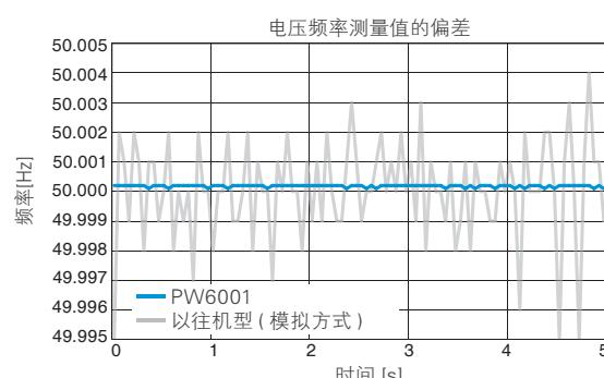
\*基本精度±0.01Hz在数据更新50ms以上的情况下规定。
