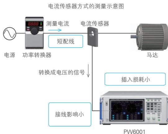
与直接接线方式相比，可在接近功率转换器实际工作环境的状态下进行测量。
