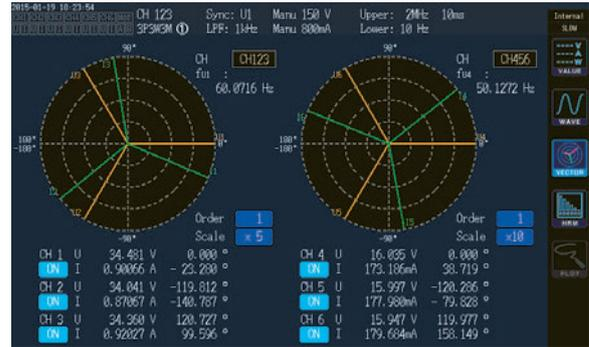
功率基本精度  $\pm 0.05\%$  ( $\pm 0.02\%$  rdg.  $\pm 0.03\%$  f.s. 主机精度)
