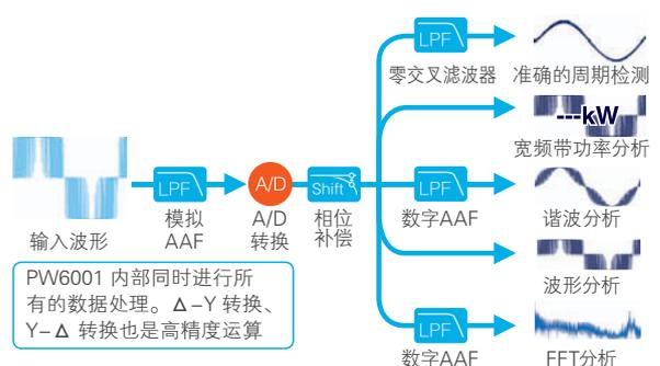
\*AAF(模拟防混淆滤波器): 采样时预防发生的折回误差的滤波器
