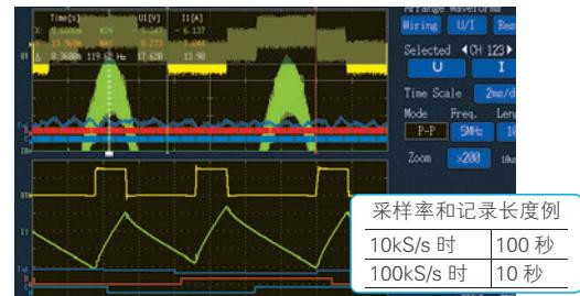
基于电平触发，Ver3.00新版本具备通过有效值和频率变化的事件触发功能。而且无需示波器，通过光标测量功能、波形缩放功能即可进行波形分析。
