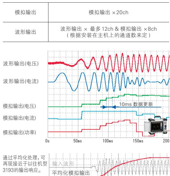
\* 波形输出时能够按1MS/s输出，忠实再现最大到50kHz的正弦波。
