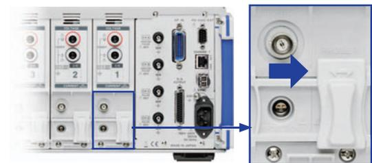
宽频带探头用端子：将滑盖向右移动。
