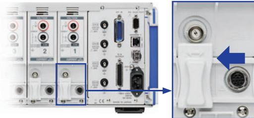
高精度传感器用端子：将滑盖向左移动。
