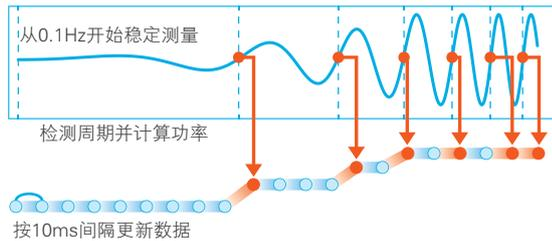
从低频到高频，即使频率变动也能自动追踪基波。也标配了△-Y、Y-△转换，进行高精度运算。
