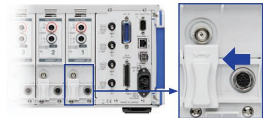
高精度传感器用端子：将滑盖向左移动。
