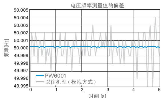
\*基本精度±0.01Hz在数据更新50ms以上的情况下规定。
