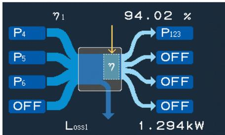
将功率调节器等效率的运算公式简单设置到专用画面中。最多同时显示4个系统的效率和损耗运算。
