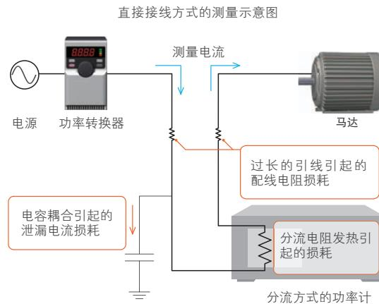
直接接线方式的测量示意图
