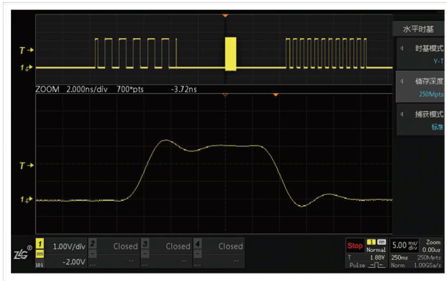
250M 存储深度下, 采样率保持在 1G, 波形细节清晰可见
