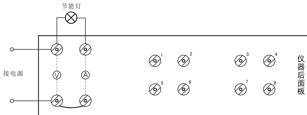
图 10 节能灯整灯的测试接线图
