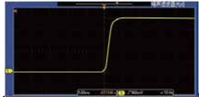
LED测试无过冲电流
