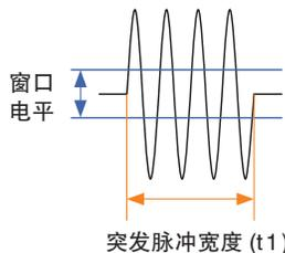
求出突发脉冲宽度信号被输出的时间
