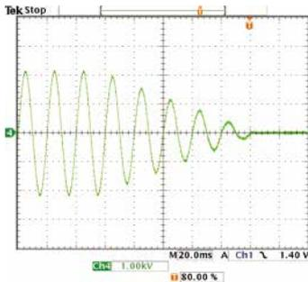
在交流耐电压测试的 PASS 判断时，可以使测试电压缓慢下降。电压下降时间可以在 0s-200s 范围内按 0.1s 级别进行设定（也可以关闭）。
