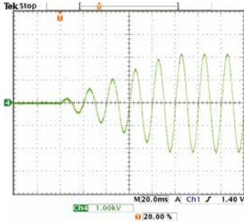
在交流耐电压测试时，配备有缓慢升压至设定电压值的上升时间控制功能。电压上升时间可以在 0.1s-200.0s 范围内按 0.1s 级别进行设定。
