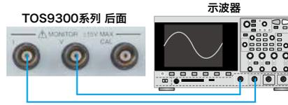
可以通过 BNC 电缆连接示波器。
