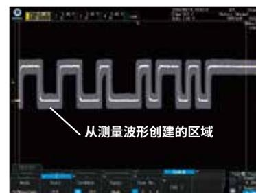
通过上/下/左/右移动测量波形，在创建的区域中搜索波形。
