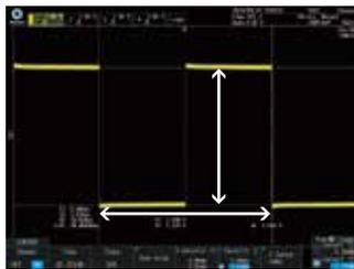
使用 $\Delta T$  &  $\Delta V$ 光标同步测量电平和时间差
