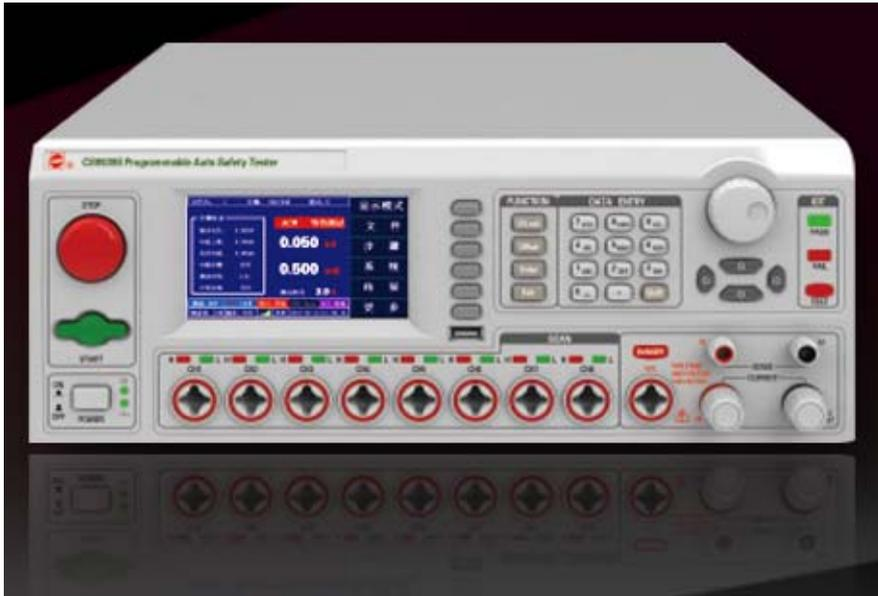
程控多路安规测试仪是安规行业第一批精密 8/4/14/16 路扫描矩阵耐压、绝缘电阻测试仪。输出电压采用硬件反馈，高速 MCU 控制技术，输出电压稳压率范围在 1% 以内。使其特别适用于对电子变压器、电线电缆、电源线、接插件、线路板的扫描测试使用
