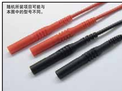
Model 8607 1kV 源香蕉电缆组: 8607 电缆组由一条红色和一条黑色黑色高压测试线组成, 两端有固定的安全香蕉插头。测试线长 1 米 (3.3 英尺), 额定电压为 1500V DC。
