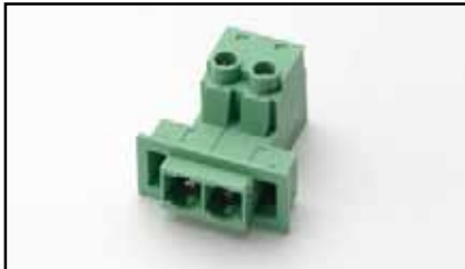
CS-1626-2: 2 针孔式螺丝端子连接器模块。50A 额定值。与 Model CS-1592-2 螺丝端子连接器配对使用。
