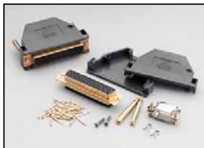
Model 3791-KIT78-R: 78 针孔式 D-Sub 连接器套件，包含两个孔式 D-Sub 连接器和 156 个焊锡坑触点。用来组装定制电缆及兼容 Series 3700A 插件的线缆。
