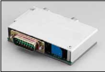
Model 3706-BKPL: 模拟背板扩展电路板，15 针 D-Sub 到端子块。
