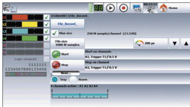
触发：几种不同的触发，一个通道，一个等级，斜率，几个通道或组合条件。
