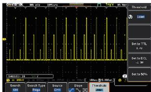
使用者可依据触发条件，快速地找到有兴趣的波形。当启动搜寻功能后，荧幕将以空心的倒三角形来显示符合触发条件的位置，荧幕的左上方 Overall 会显示符合触发条件的所有波形数量。使用者可依据 Edge, pulse width, Runt, Rise/Fall 及 Bus 等触发条件来设定波形搜寻。MDO-2000E 的前面板可控制波形缩放和播放 / 暂停功能，以快速找出每一个感兴趣的事件。
