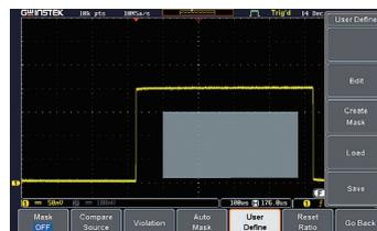
MDO-2000E 系列提供掩码测试 (MASK) 功能，使用者可以设定自动屏蔽 (Auto Mask) 与使用者定义 (User define) 的屏蔽，来判定产品的质量或是是否合乎测试规范。透过使用者定义的屏蔽，使用者可设定最多 8 个区域，每个区域最多 10 个点，以达成测试规范设定的需求。
