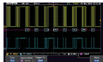
MDO-2000E 系列数字示波器采用先进的 VPO(Visual Persistence Oscilloscope) 信号处理引擎, 提供每秒高达 600,000 次 (分段模式), 120,000 次 (正常模式) 的波形更新率及多层次余晖显示来让用户可更有效地进行测瞬信号判断增进电路除错效率, 强大的 VPO 信号处理引擎能在极短时间内将所获取的振幅, 时间关系和信息强度的三维数据信息进行分析, 并显示于示波器画面上, 相较于一般传统的数字存储示波器, MDO-2000E 提供了丰富的波形信息于画面上, 协助用户做最正确的判断。
