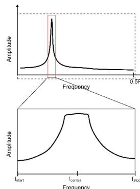
MDO-2000E 的频谱分析仪还包括频谱轨迹设置 (正常, 最大保持, 最小保持和平均)。用户可以自由选择各种频谱轨迹同时显示。可以为每个轨迹单独设置检测方法 (Sample, + Peak, -Peak 和 Average)。此外，用户通过游标 (Cursor) 可以手动标记相应的位置以反映频率和幅度。搜索功能也可以应用于对频谱的峰值表。幅度以 dB 显示，标记可以获得测量数据。下图显示的为 FM 信号的频谱。用户可以使用搜索功能来搜索和标记多个幅度和频率，搜索方法包括最大峰值和阈值，可以显示和保存测量结果。
