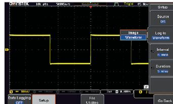
资料纪录功能可依测试需求，设定储存档案的期间与间隔。纪录时间可选择 5 分钟至 1000 小时；储存间隔最短为 5 秒。储存资料可选择波形或各通道的 CSV 档案。储存的资料亦可选择存于 U 盘，示波器内部或透过 LAN 储存于远端的计算机内。
