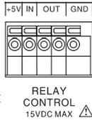
共有 5 个端口，一个+5V 输出端，一个 GND 端，一个逻辑电平输入端，两个为继电器控制端。其用法请参见第 39 页。
