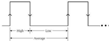
波峰值测量和平均值测量都以脉冲电流的上升沿来触发的，并按设定的时间进行测量；波谷值测量时脉冲电流的下降沿来触发的，并按设定的时间进行测量。
