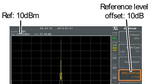
设置参考电平偏移后(offset: 10dB)
