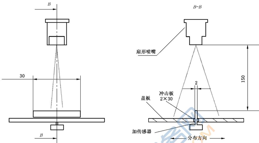
注：扇形喷嘴的流量调整在 $(15 \pm 1)$  L/min 内，实现  $0.9 \text{ N} \sim 1.2 \text{ N}$  的冲击力分布，试验过程中的水温保持在 $(20 \pm 5)^\circ\text{C}$ 。
