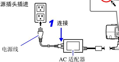
**2** 将输出插头连接到本仪器上
