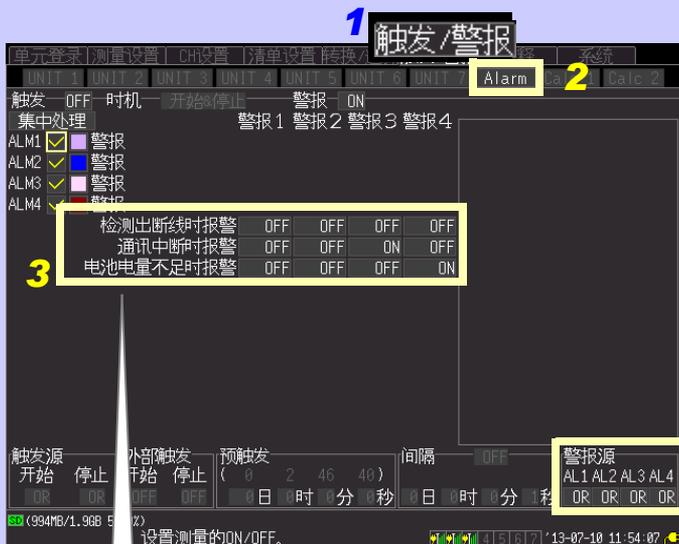
■ 将 [检测出断线时报警] 设为 [ON]
