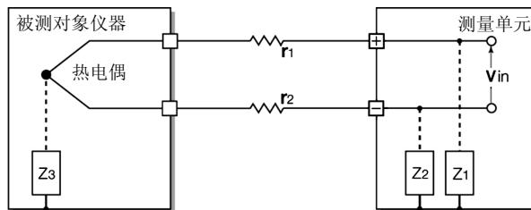
在热电偶温度测量中，如果被测对象仪器与测量单元双方均未接地，则会受到噪音的影响。
