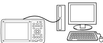
**1** 注意端子的方向，同时插入 USB 连接线的插头
