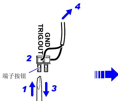
将 + 线连接到 TRIG.OUT（或 EXT.TRIG）端子上，将 - 线连接到 GND 端子上。
