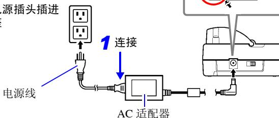
**2** 将输出插头连接到测量单元上
