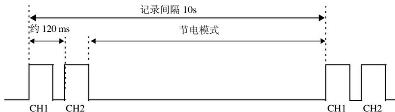
通道 1 与通道 2 的扫描结束之后，会进入节电模式，因此与 15 通道的测量均为 ON 时相比，可延长节电模式的时间。要进一步延长电池的使用时间时，可限定要测量的通道。
