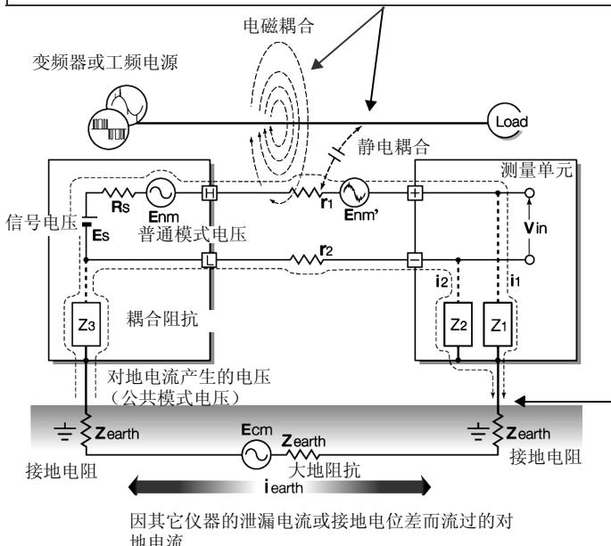
被测对象仪器侧的接地点与测量单元的接地点之间存在大地阻抗，地线与噪音源产生电容耦合而形成公共模式噪音。
