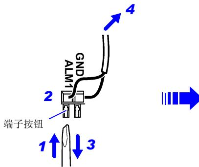
将 + 线连接到 ALM1（或 ALM2 ~ ALM4）端子上，将 - 线连接到 GND 端子上。
