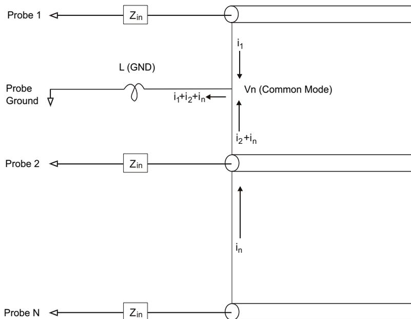
**图 24** 共模输入电压模型
