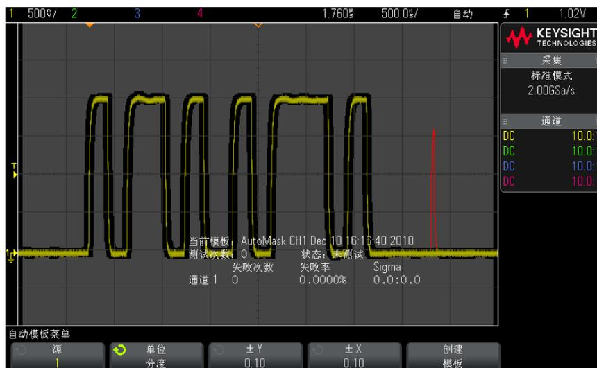
9 要清除模板并关闭模板测试, 可按下 **Back** 返回 / 向上键以返回“模板测试菜单”, 然后按下**清除模板**软键。
