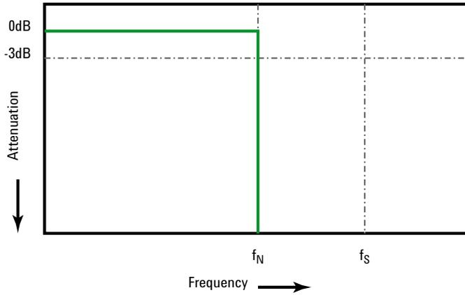
图 34 理论上的砖墙频率响应
