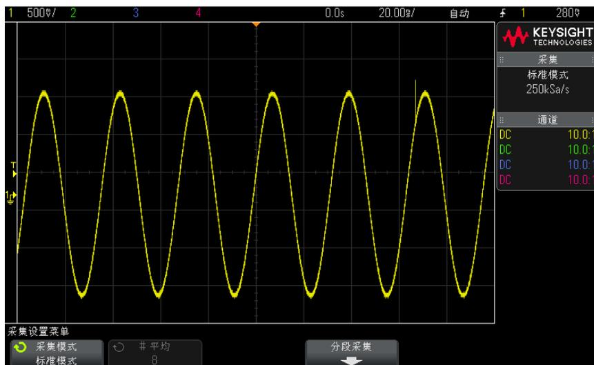
图 36 带毛刺的正弦波，正常模式
