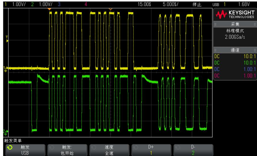
6 按下**触发**：软键选择 USB 触发将发生的位置：
