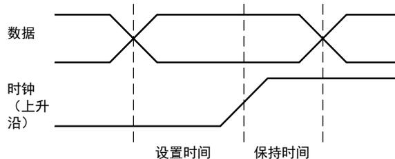
一个示波器通道将探测时钟信号，另一个通道将探测数据信号。
