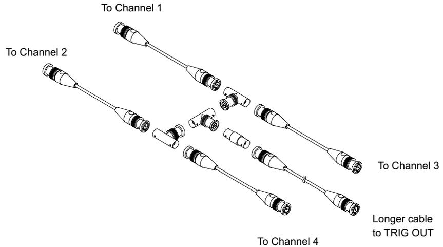
图 50 用于 4 通道示波器的用户校准电缆
