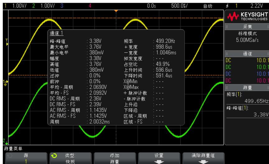
还可以配置 **[Quick Action]**（快速操作）键以显示“全部快照”弹出框。请参见“配置 **[Quick Action]**（快速操作）键”（第 278 页）。
