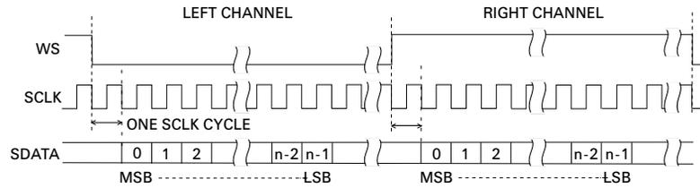
**WS 低 = 右通道** — 右通道数据对应于“WS= 低”；左通道数据对应于“WS= 高”。
