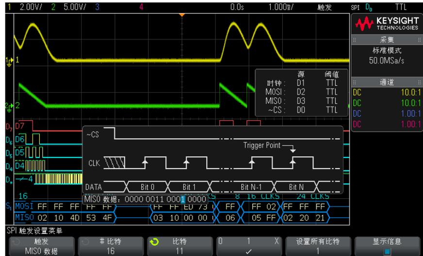
设置**所有比特**软键将数据字符串中的所有比特设置为 **0 1 X** 软键的值。
