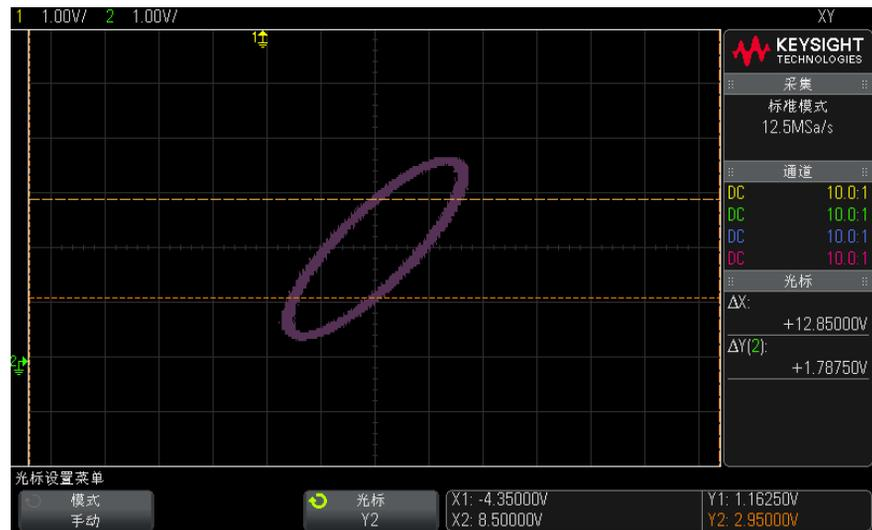
图 4 相差测量，自动和使用光标
