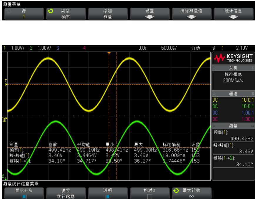
显示以下统计信息：测量名称、当前测量值、平均值、最小测量值、最大测量值、标准偏差以及进行测量的次数（计数）。统计信息基于所捕获的波形的总数（计数）。
