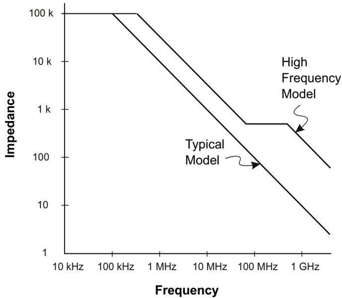
图 23 两个探头电路型号的阻抗和频率
