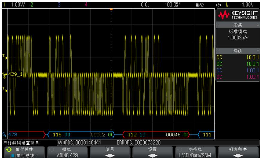
根据所选的字解码格式，ARINC 429 解码显示颜色设置如下：
