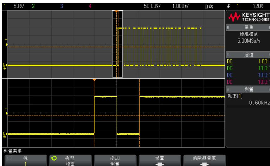
图 48 隔离频率测量事件
