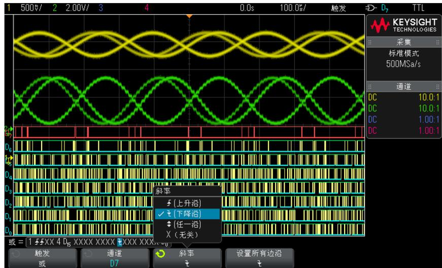
如果 OR 触发中的所有通道均设置为“无关”，则示波器将不触发。
