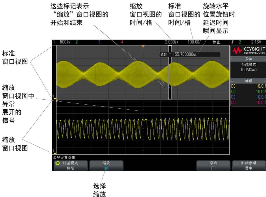
正常显示的展开区域用一个框框起来，正常显示的其余部分将呈灰显状态。该框显示在下半部分中展开的正常扫描部分。
