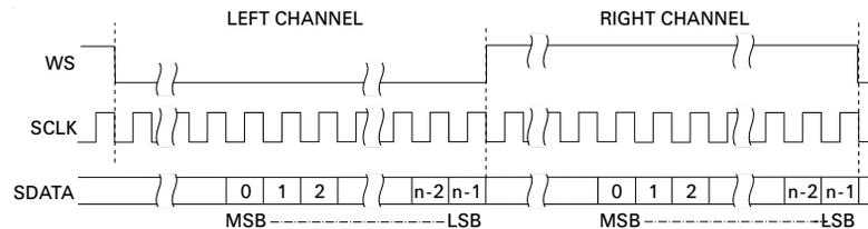
**12** 按下 **WS 低** 软键，然后，旋转 Entry 旋钮以选择“WS 低”表示左通道数据还是右通道数据。屏幕上的示意图将随着您的选择而更改。
