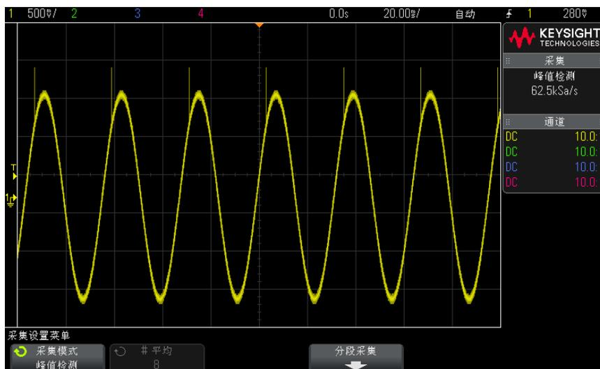
图 37 带毛刺的正弦波，峰值检测模式
