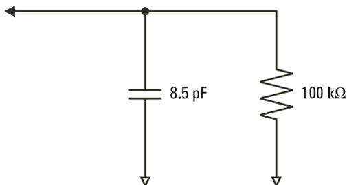
图 21 直流和低频探头等效电路
