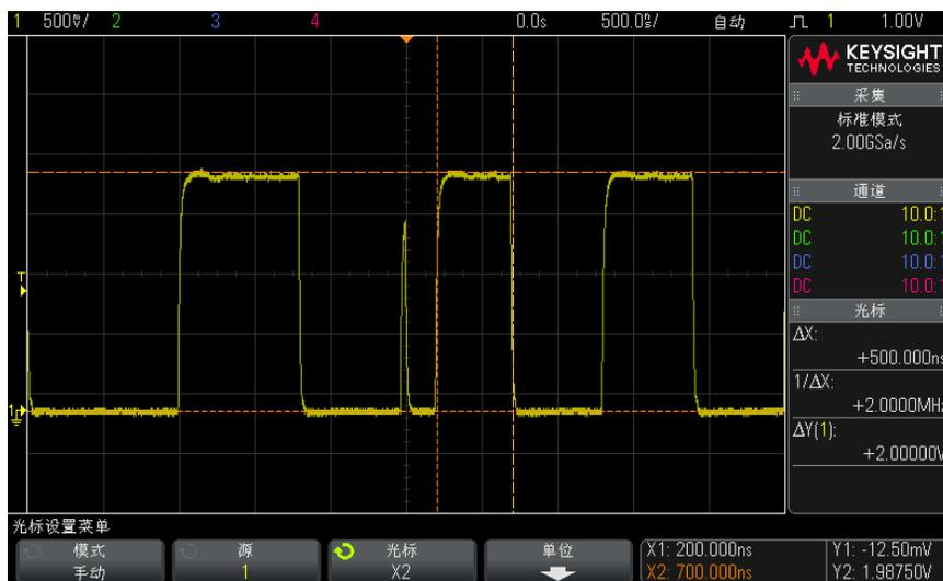
图 43 用光标测量脉冲宽度
