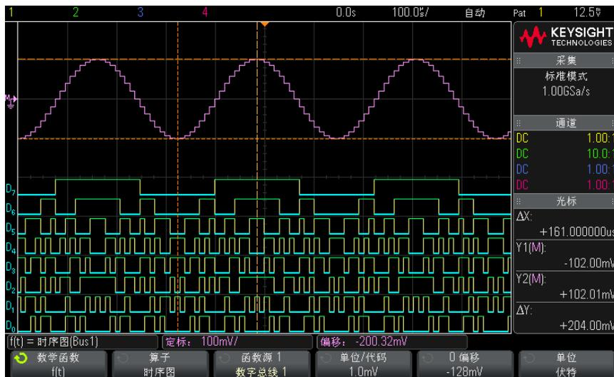
图 18 逻辑图总线时序示例
