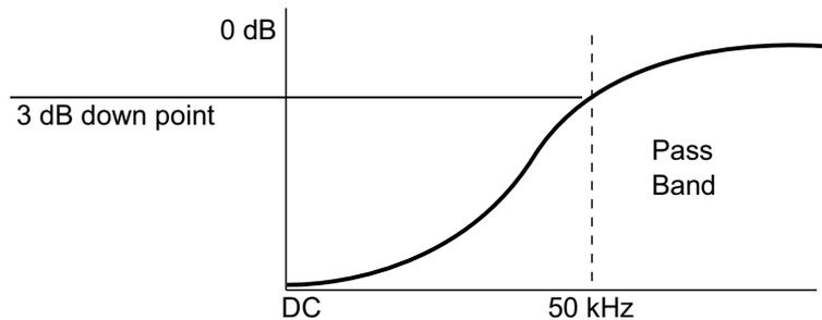
低频抑制从触发波形中移除任何不必要的低频率分量，例如，可干扰正确触发的电源线频率等。
