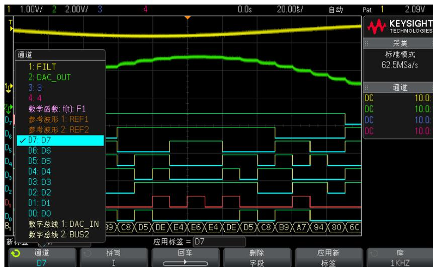
上面的图显示通道的列表和它们的默认标签。将标签分配给通道并不要求打开通道。
