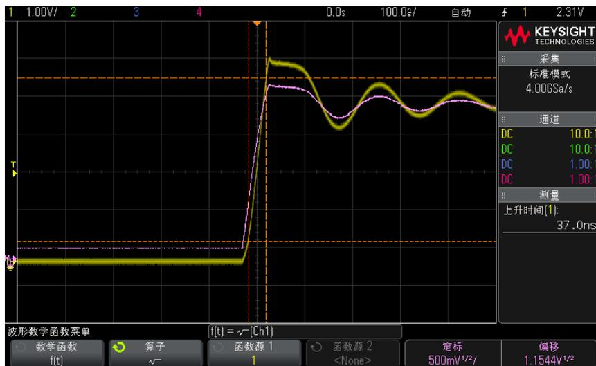
图 10  $\sqrt{\quad}$  (平方根) 的示例
