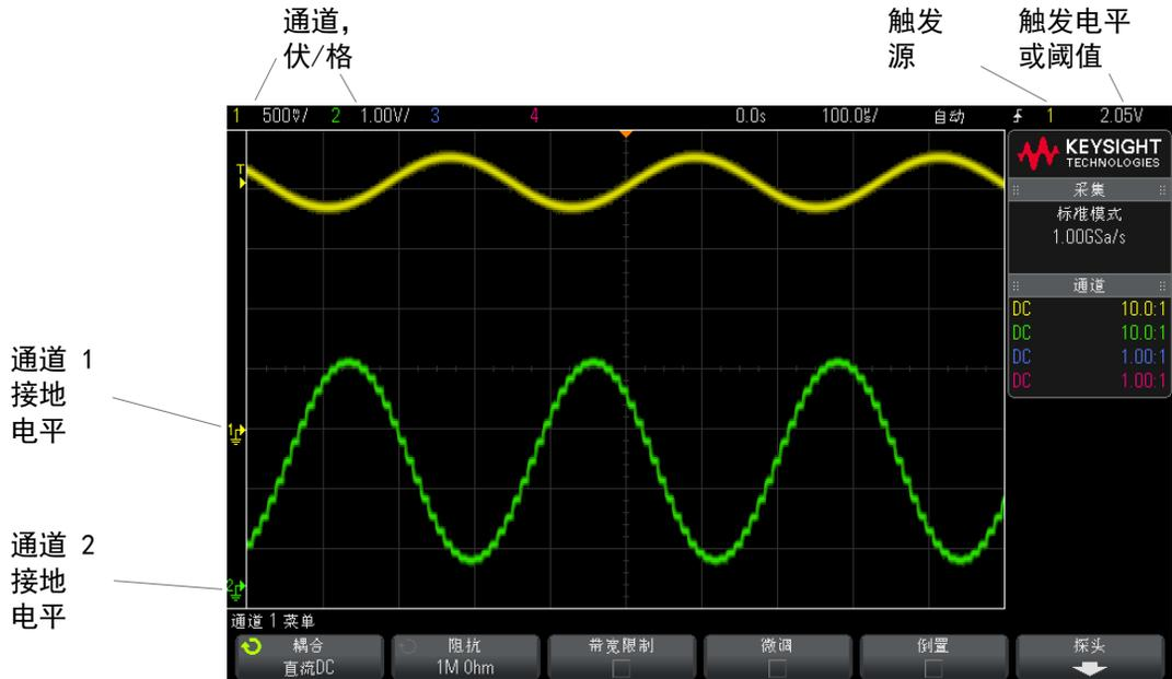
每个显示模拟通道的信号的接地电平由显示屏最左侧的
