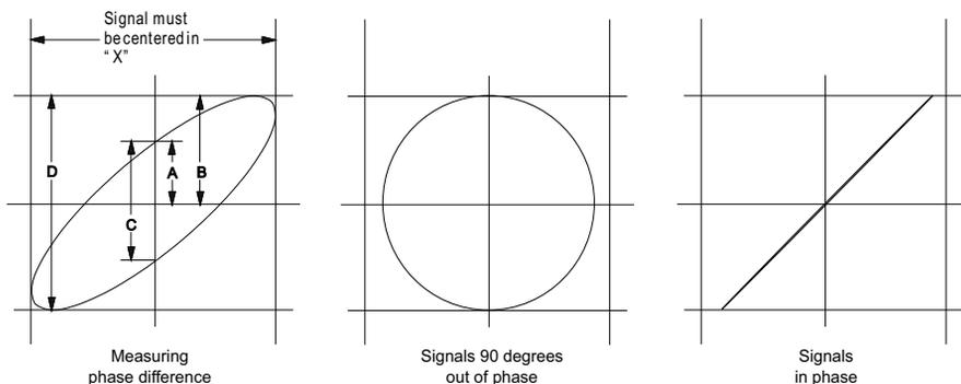
**图 3** XY 时间模式信号，在显示屏上居中
