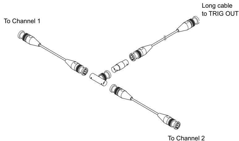
**图 49** 用于 2 通道示波器的用户校准电缆
