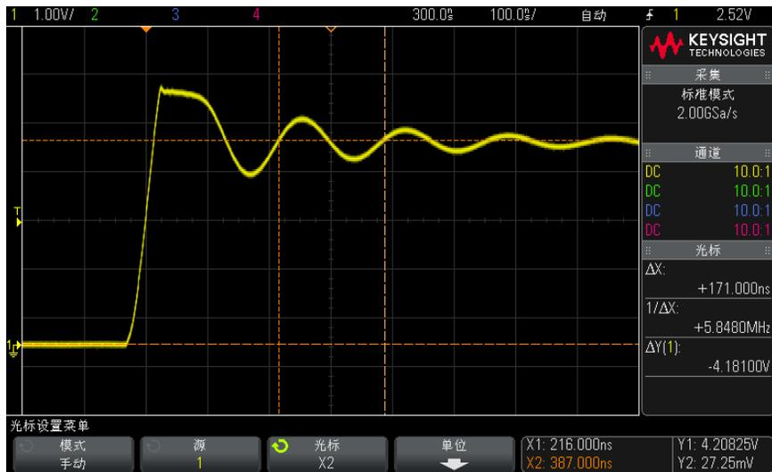
图 41 光标测量脉冲振铃频率
