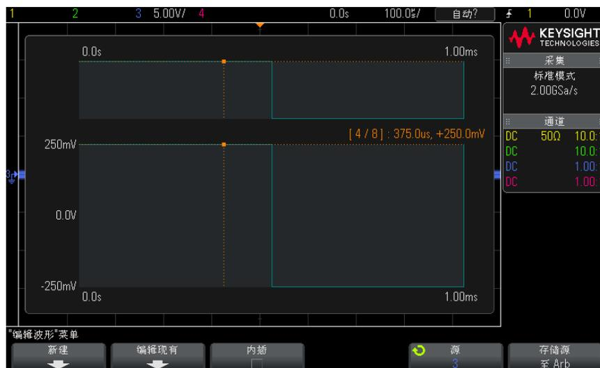
打开“编辑波形菜单”后，可以看到现有的任意波形定义。在图中看到的电压和时间周期是限制参数 — 它们来自主“波形发生器菜单”中的频率和幅度设置。
