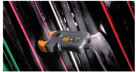
导线位置的影响(DC, 50/60Hz时) ±0.1%rdg.以下(CT6844)、±0.2%rdg.以下(CT6845, CT6846)
