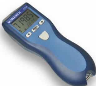
PT99 是数字式便携光电非接触转速表，测量距离为 5-92 厘米，采用红色 LED 光源，由 2 节 AA1.5V 电池供电，可同时对准被测物并查看测量数据，符合人体工程学设计、使用安全、橡胶防滑表面方便单手握持操作，是美国 MONARCH 出品的世界领先的便携式转速表。
