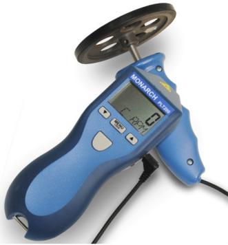
PLT200 是一种数字式便携激光转速表，由两节 5 号电池供电，测量距离可达 7.6 米。使用 2 级激光光源，使用安全，可同时对准被测物并查看测量数据。符合人体工程学设计，方便单手握持、操作。
