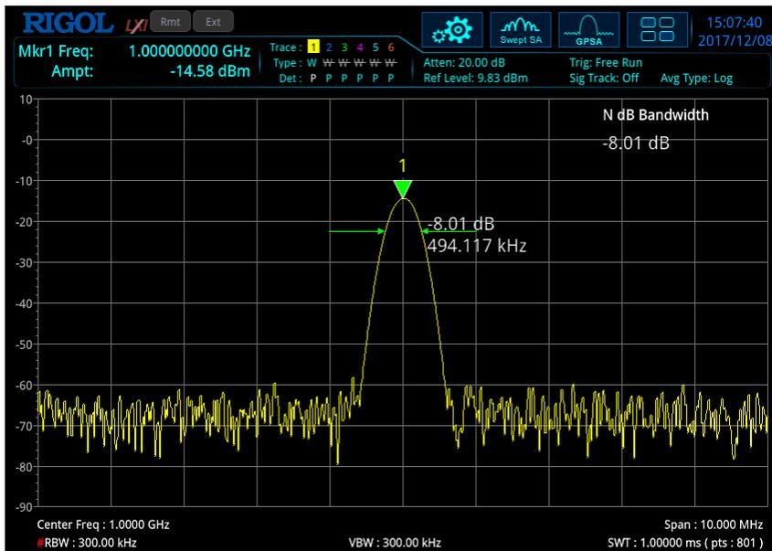
图 2-16 N dB 带宽测量示意图
