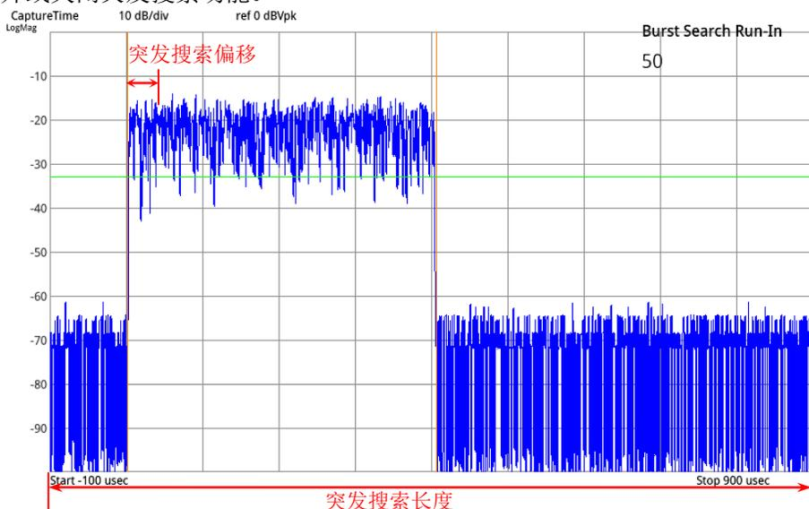
图 5-5 突发搜索参数关系图
