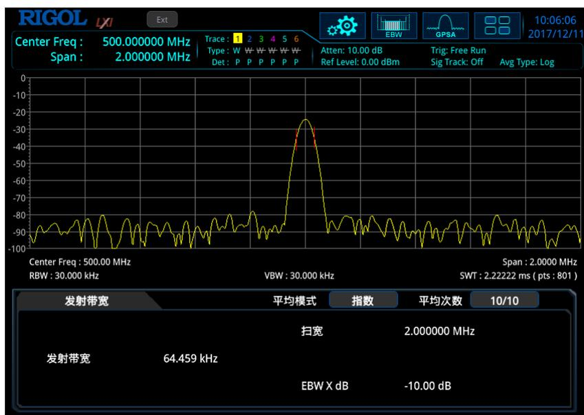
图 2-9 发射带宽测量界面
