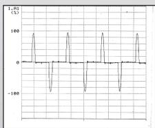
逆变器(输入侧)的电流波形
