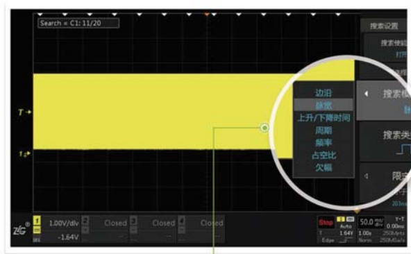
设置搜索条件，支持边沿、脉宽、欠幅、上升/下降时间、周期/频率多种搜索条件
