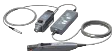
电流探头 0.5, 5, 30Arms, 702915 (DC ~ 50MHz), 702916 (DC ~ 120MHz)
