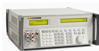
5522A 超级多产品校准器 (0.0011%)
