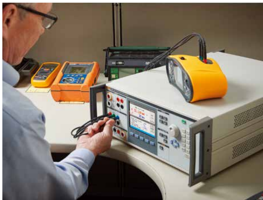
每台 5322A 都配有一个外部 R 倍增器, 用于输出测试绝缘测试仪所需的高达 10 TΩ 电阻。
