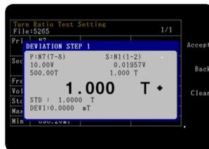
**電感法 / 電壓法量測圈數比功能**
