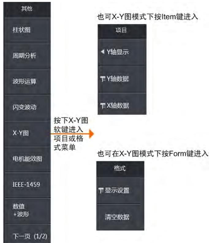
图 17.2 X-Y 图的项目和格式菜单
