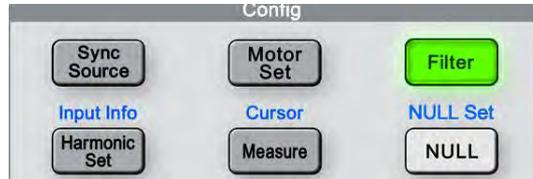
图 5.16 显示项目与输入单元设置按键区
