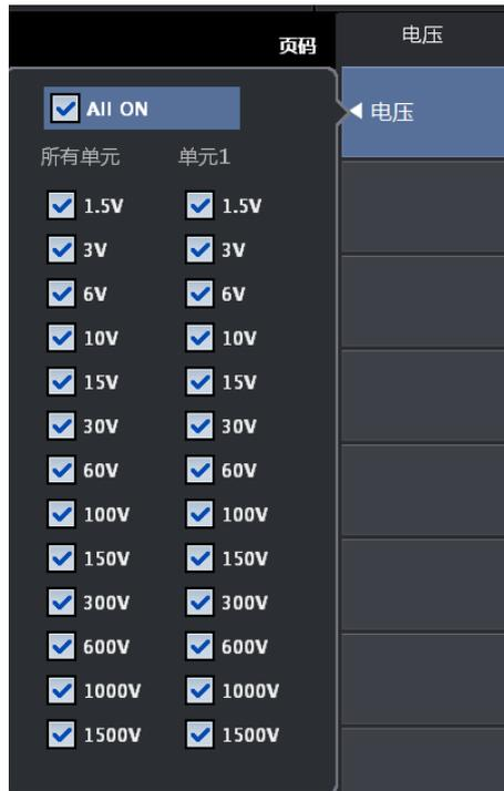
图 5.12 PA5000H 电压测量范围量程
