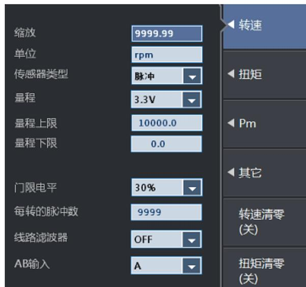
图 21.7 转速输入量程
