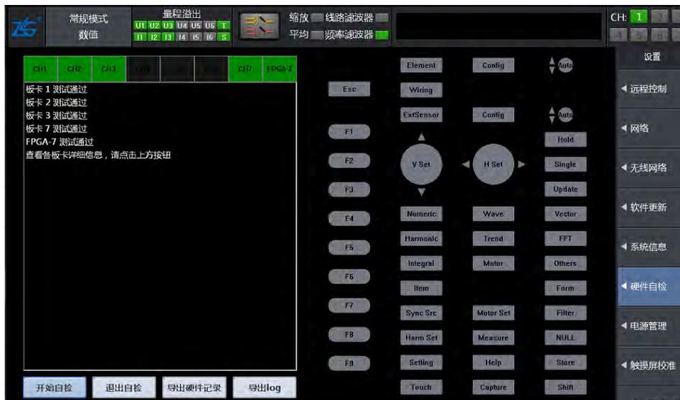
图 23.24 单元/FPGA 自检结果
