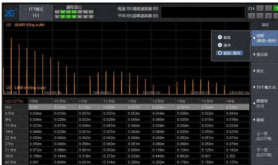
图 11.4 FFT 视图显示格式
