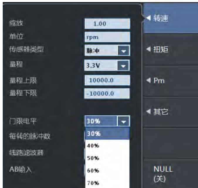
图 21.13 转速信号的手动门限配置
