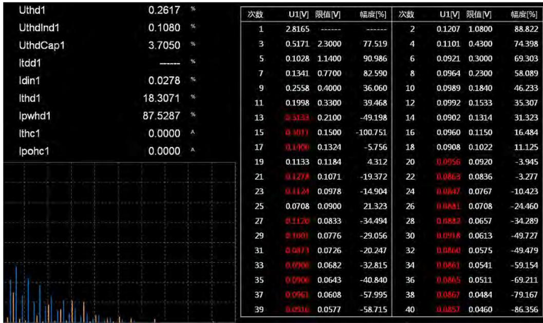
图 4.13 IEC 谐波测量所有视图
