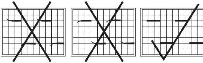
正確調整 200Hz 方波的示意圖
