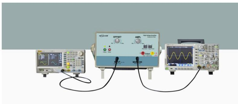
A. 将函数波形产生器的频率设定在  $0 \sim 200 KHz$ 。(频率超过不会对 HA-1600 产生任何破坏, 但输出会压缩及变形)
