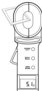
测试环上的标称值是在温度为 20℃ 下的值。显示值与标称值相差一个字，是正常的。如：测试环的标称值为 5.1 Ω 时，显示 5.0 Ω 或 5.2 Ω 都是正常的。显示“OL Ω”，表示被测电阻超出了钳表的上量限，见图 3。显示“L0.01 Ω”，表示被测电阻超出了钳表的下量限，见图 6。
