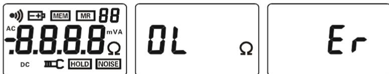
自检过程中，不要扣压扳机，不能张开钳口，不能钳任何导线。
