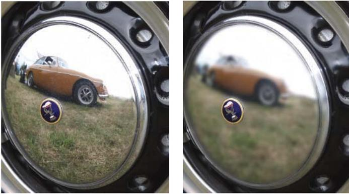
反射雾影是与涂料和抛光材料有关的常见问题。出现反射雾影的表面外观“浑浊”，反射成像“浅”。使用 Rhopoint IQs 可直接测量评估这一重要特性。
