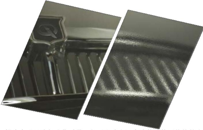
橘皮会明显降低成像质量，却不影响光泽度读数。使用传统的光泽度计测量这两个测试面板时，测量结果完全相同。
