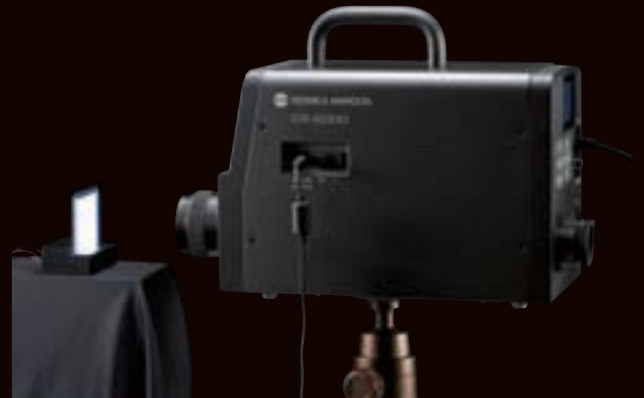
测量实例： 测量一块研发阶段时的有机电致发光(Organic EL)平板
