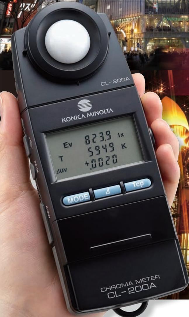
仪器小巧，轻便，测量探头可拆卸。随机附送操作简便的数据管理软件。
