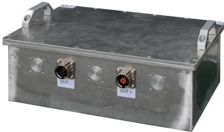
HVSE 200 转接盒适用于 ISO 7637-4 中 A 波 C 波的共模/差模测试转换。通过对插相应的端口，即可实现共模/差模测试的转换。该转接盒可帮助用户免去复杂繁冗的接线方式，具有可操作性强，屏蔽效果好等优点。
