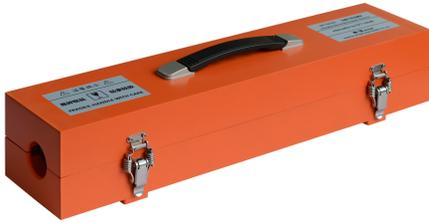
EMID 1M电磁干扰去耦夹用于电快速瞬变脉冲群抗扰度试验 (GB/T 17626.4、IEC 61000-4-4) 中的干扰信号去耦,可以将瞬变脉冲群信号衰减20 dB以上。也可用于1 MHz以上干扰信号的衰减,衰减系数大于10 dB (与信号频率有关)。本产品采用卡扣式结构,可以直接套在待去耦的线缆上,使用方便。同时去耦夹还具有与去耦线缆物理隔离的特点。
