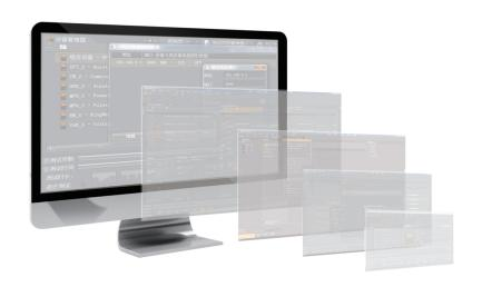
EMS lab 是 EMS 电磁兼容测试平台的配套软件,软硬件一同构成整个测试系统,可完成群脉冲、雷击浪涌、跌落、电压变化、工频磁场和脉冲磁场模拟波形测试功能。Ems lab 参照相关标准,可提供预定义的测试参数,并提供标准库测试波形,极大的方便用户的使用;自动化测试序列,实现远程一键测试操作,操作更简便。
