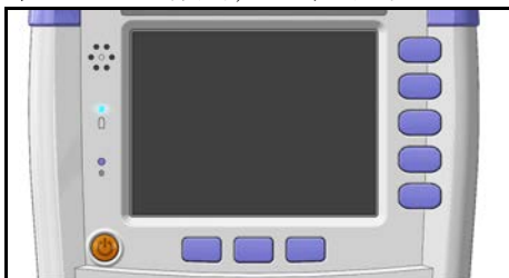
图 3-3 充电指示灯，充电时显示为蓝色
