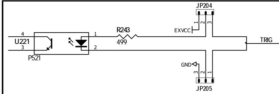
图中：JP204 和 JP205 出厂配置为 1-2 短接。触发信号为上升沿触发。
