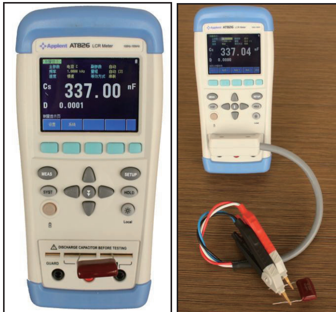
图 7-1 电容器的测试结果
