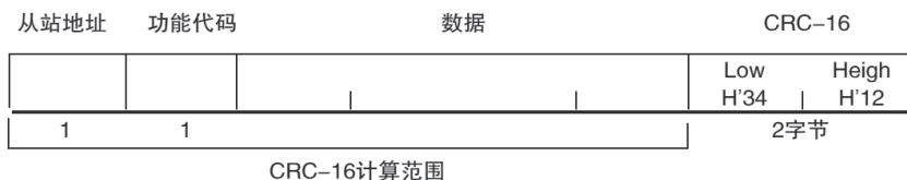
图 10-2 Modbus 附加 CRC-16 值
