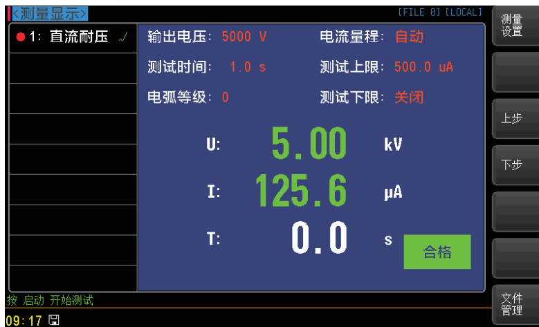
图 6-3 直流耐压测量界面
