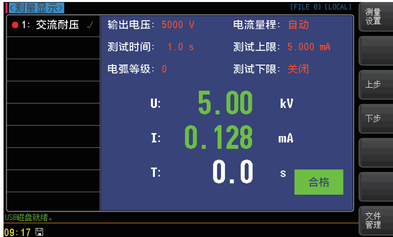
图 6-2 交流耐压测量界面
