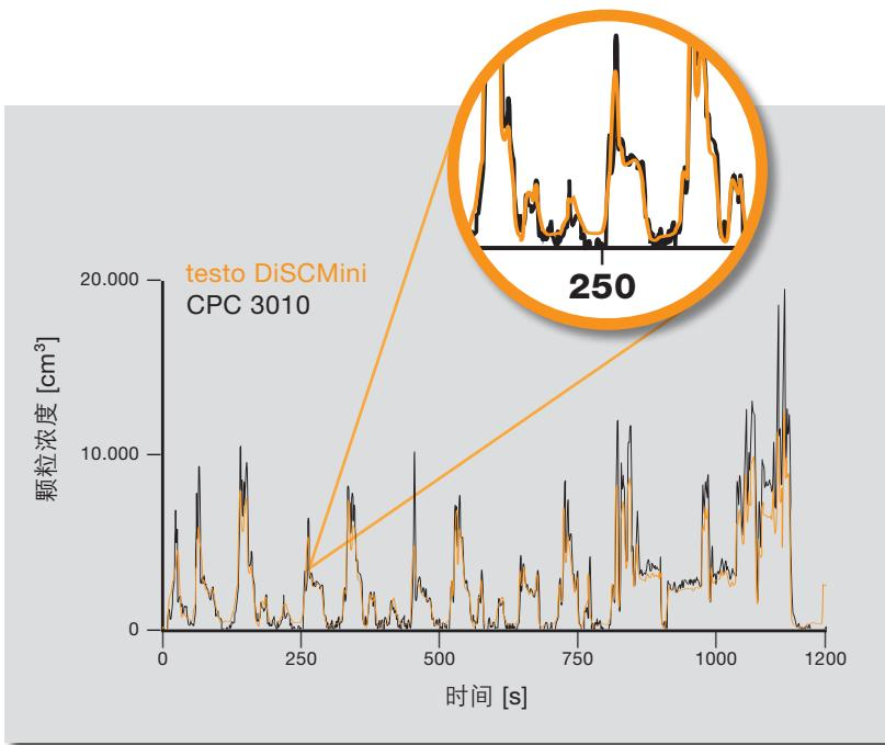
与CPC装置相比，testo DiSCmini可以真正做到手持，便于使用。它不仅提供颗粒数浓度，还可以提供平均粒径，以及肺表面沉积数据。它可以测量直径小于半个微米的颗粒。
