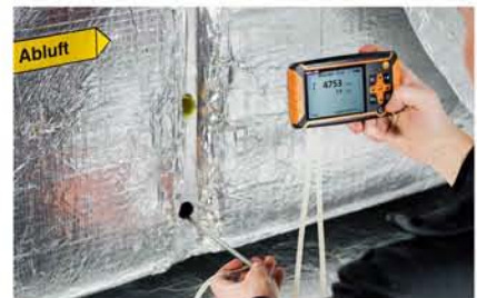
testo 420 并非单一风量测量功能, 其主机可作为单独绝压、压差测量仪进行管道压力、风速、风量检测, 还具备温湿度测量功能, 一机多用, 专业通风系统检测工具。
