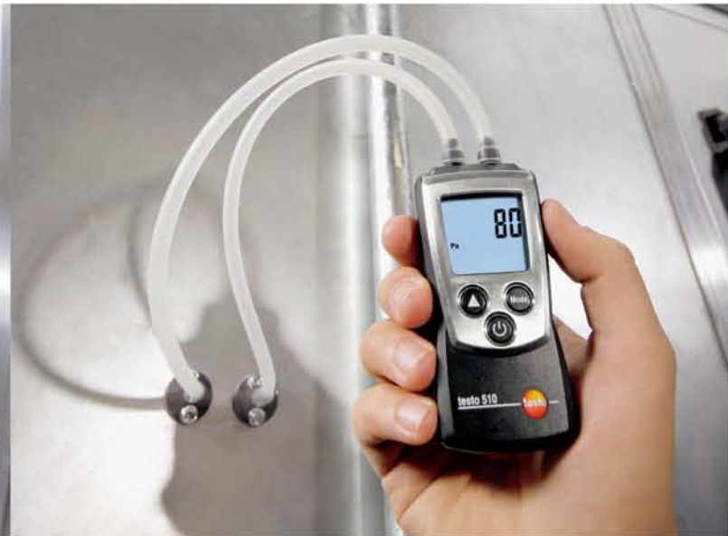
利用testo的压差测量仪器（例如test 510压差仪），可以快速可靠地检查过滤器是否变脏堵塞。
