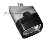
E1: 前面的座圈没有正确固定。如果E1信息出现,仪器必须关机。拿走前面的座圈,复位反射器,固定前面的座圈 (①).
