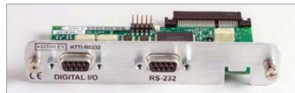
KTTI-RS232 RS-232 接口及 6 个 I/O 端口
