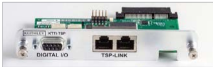
KTTI-TSP TSP-Link 接口及 6 个 I/O 端口。
