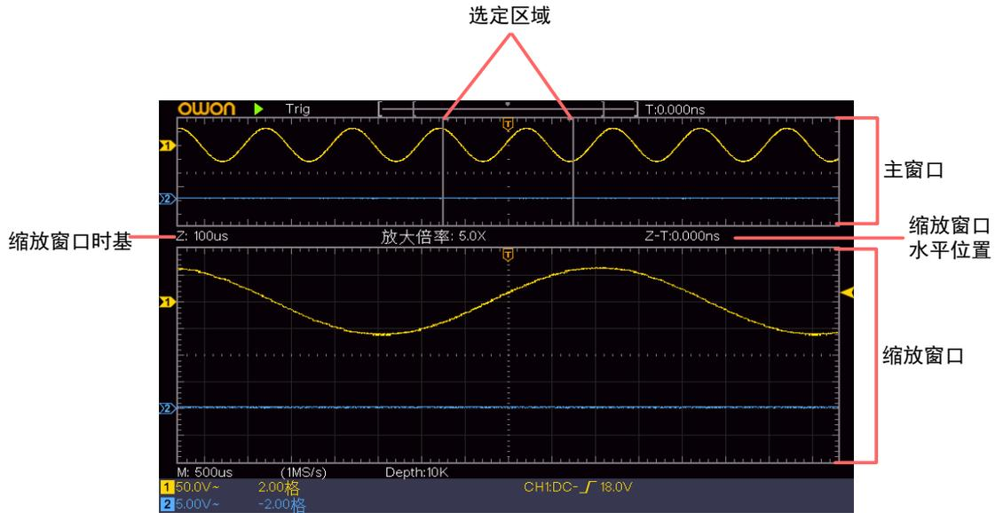
正常模式下，**水平位移** 旋钮和 **水平档位** 旋钮可调整主窗口的水平位置和水平时基。
