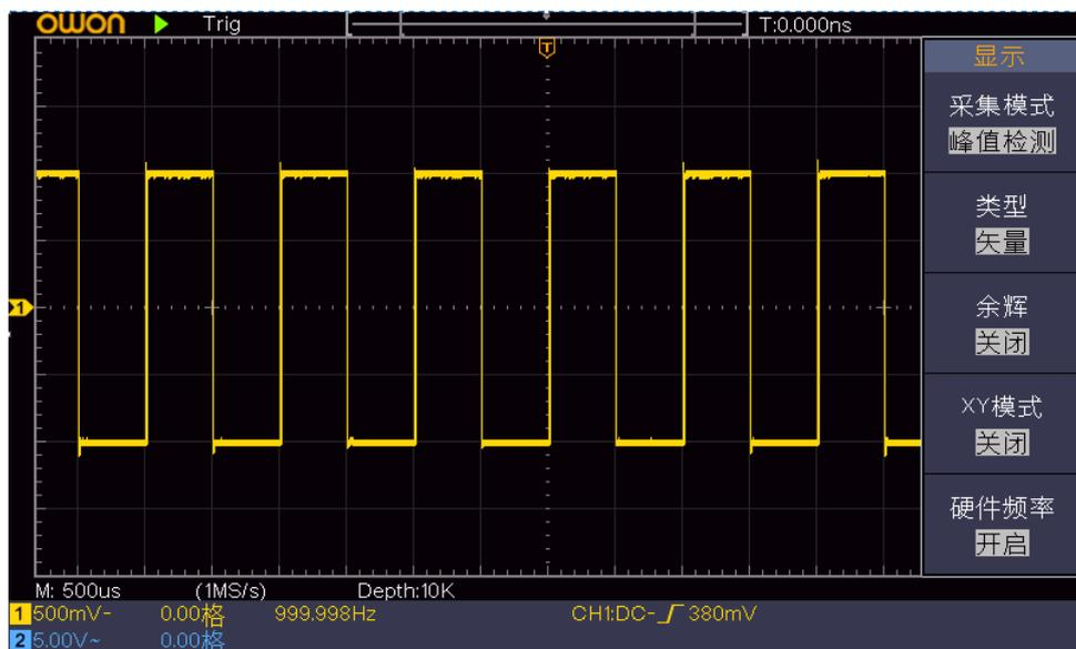
图 6-4: 含噪声信号的波形
