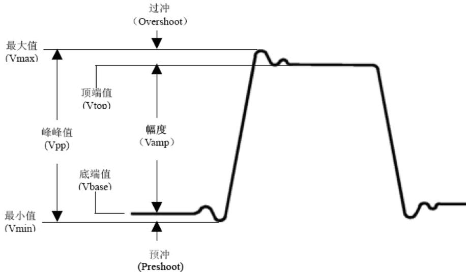
图 4-13：电压参数定义示意（顶端平整有脉冲信号）
