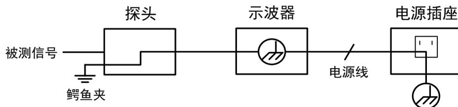
在交流供电的示波器通过端口与交流供电的计算机连接的情况下，不可以测量电网一次侧电源。
