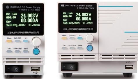
DH1790 系列是一款宽量程可编程直流电源，体积小、重量轻，电压电流覆盖范围宽，该系列提供 12 款型号，功率覆盖 180W、360W、720W、1080W；具有高分辨率、高精度、低纹波、低噪声、可编程、稳定性高等特点。具有恒压恒流两种模式输出，同时具备过压、过温、过功率等保护功能。该产品可以灵活串并联组合；可快速保存当前设置参数，便于下次使用时快速调用，标配 RS232、LAN、模拟接口。
