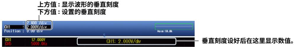
\* 当显示波形的垂直刻度和设置的垂直刻度相同时，只显示下方值。
