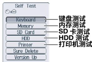
**键盘测试：** 测试前面板操作键操作是否正常、屏幕上显示的软键盘是否能正确识别输入。按键后如果相应键亮灯，那么前面板操作键操作正常。如果可以输入指定的字符，那么软键盘操作正常。
