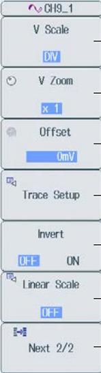
**V Scale** — 设置缩放方式 (DIV、SPAN)。
